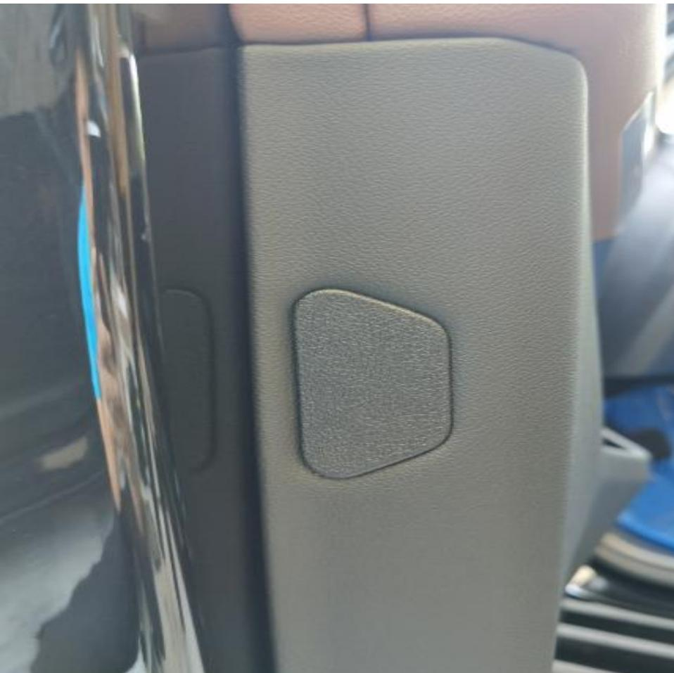
①用塑料翘板将门板侧边螺丝盖板翘开
