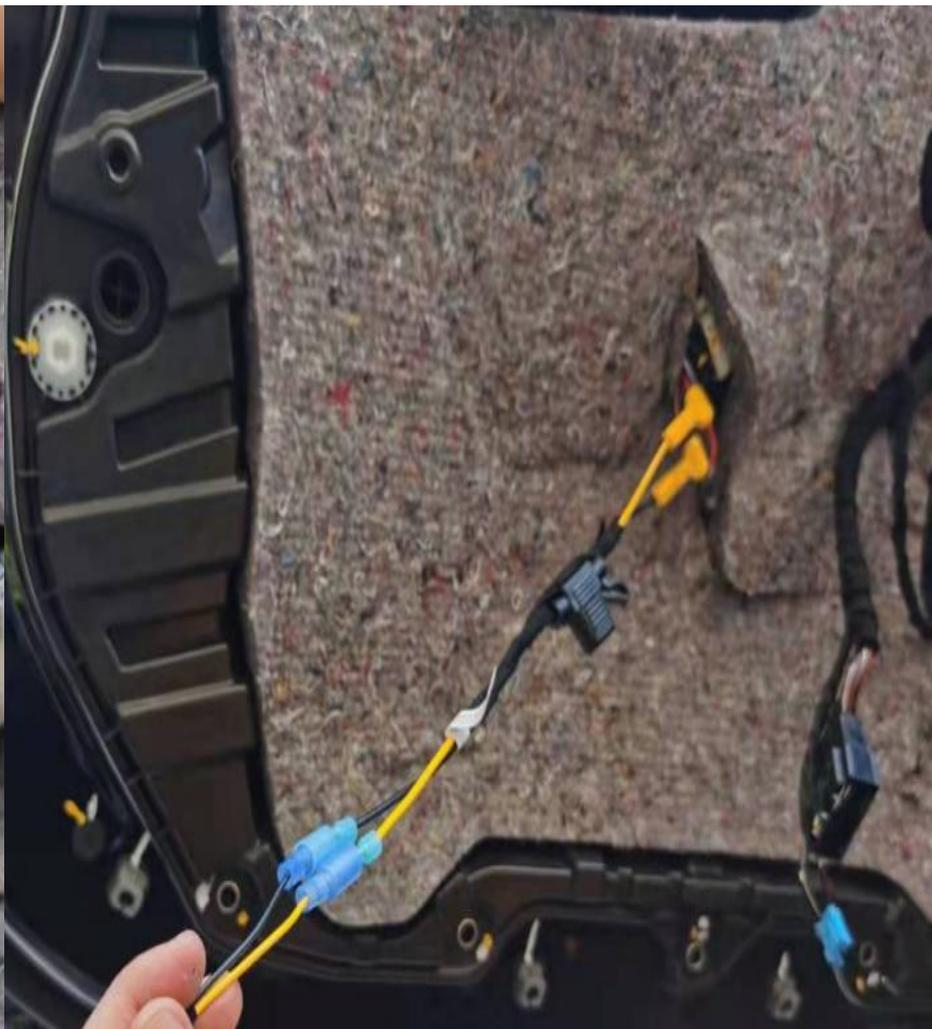
②用我司配备的线夹子进行取电(黄色线
