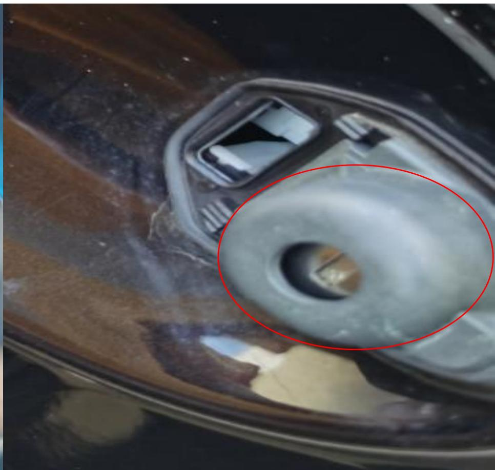
回到门板侧边孔洞处，用六角螺丝刀朝左上方向，将螺丝拧松至应急钥匙盖能拿下为止。
