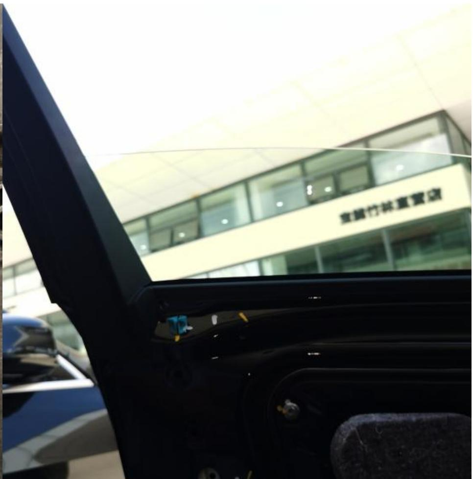
将玻璃降到底，慢慢往上升直至能看到乳黄色凹槽，用小一字螺丝刀戳入凹槽里，外里顶
