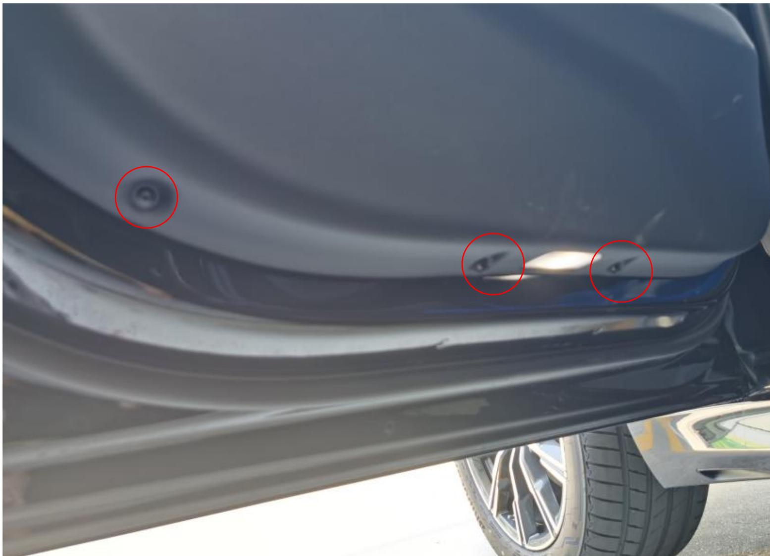
②用梅花螺丝刀将门板底部三颗螺丝拆下
