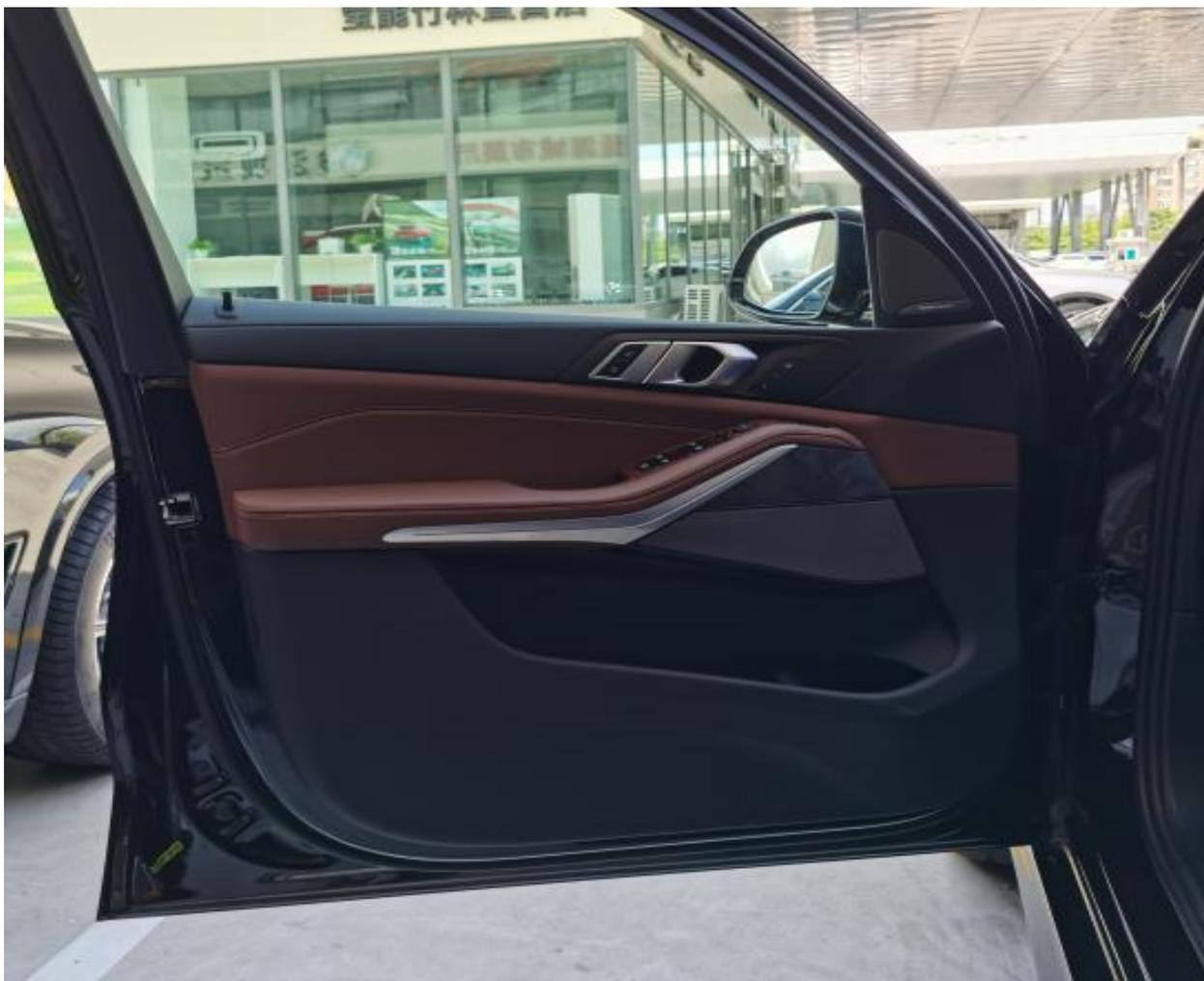
最后门板复原，复原完成后不要立马关门测试，先用螺丝刀把锁舌打到一级锁看能否工作，然后在试试内外拉手能不能拉开多测试几次在进行关门测试！
