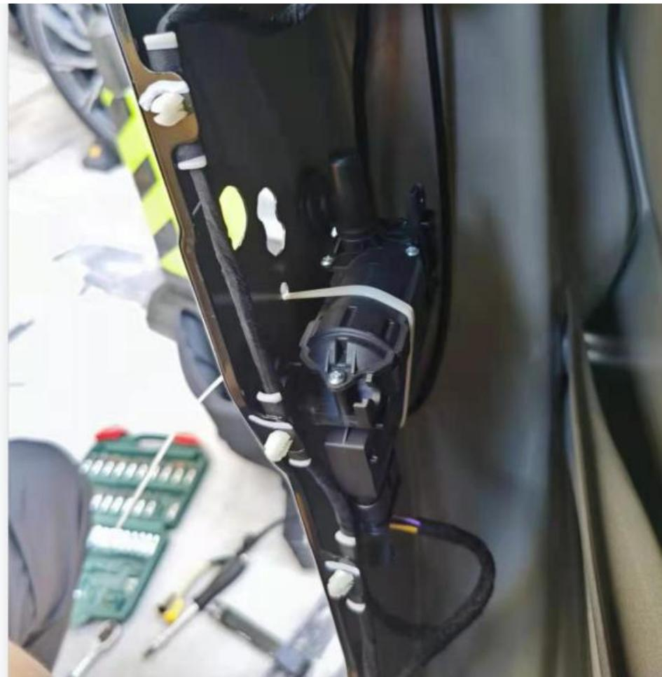
将防震胶垫装在马达箱上贴紧门板，用我司配备的轧带固定好
